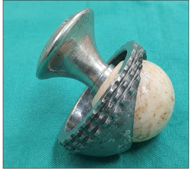
Şekil 6. Seramik liner kırığına sekonder olarak asetabular komponentte gelişen katastrofik aşınmanın intraoperatif makroskobik görünümü. Kırık sonrası eklem aralığına dağılan seramik partiküllerinin yarattığı şiddetli üçüncü cisim aşınması ve bozulan kinematik sonrası ortaya çıkan doğrudan metal teması nedeniyle asetabular metalik yapıda ileri derecede aşınma izlenmektedir.
