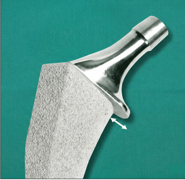
Şekil 10. Proksimali biyolojik tespiti desteklemek amacıyla pürüzlü yüzey ile kaplanmış çimentosuz femoral stem tasarımı. Ok ile işaretlenen yaka eklentisi, aksiyel yükü proksimal medial kalkara aktararak stemin çökmesini, ameliyat sırasında ve sonrasında periprotetik kırık riskini sınırlamayı hedefler.
