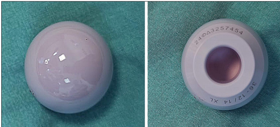
Şekil 7. Total kalça artroplastisinde kullanılan seramik femoral baş komponentinin makroskobik görünümü (solda) ve konik trunyon bağlantı yuvası (sağda). (Yazarların kendi arşivinden).
