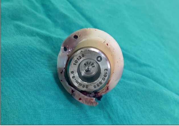
Şekil 5. Revizyon cerrahisi sırasında çıkarılmış 28 mm metalik femoral baş ve ileri derecede eksantrik aşınmaya sekonder katastrofik yetmezlik (rim kırığı) gelişmiş polietilen linerin makroskobik görünümü. İnce polietilen kullanımı ve kenar yüklenmesinin mekanik sonuçları izlenmektedir.
