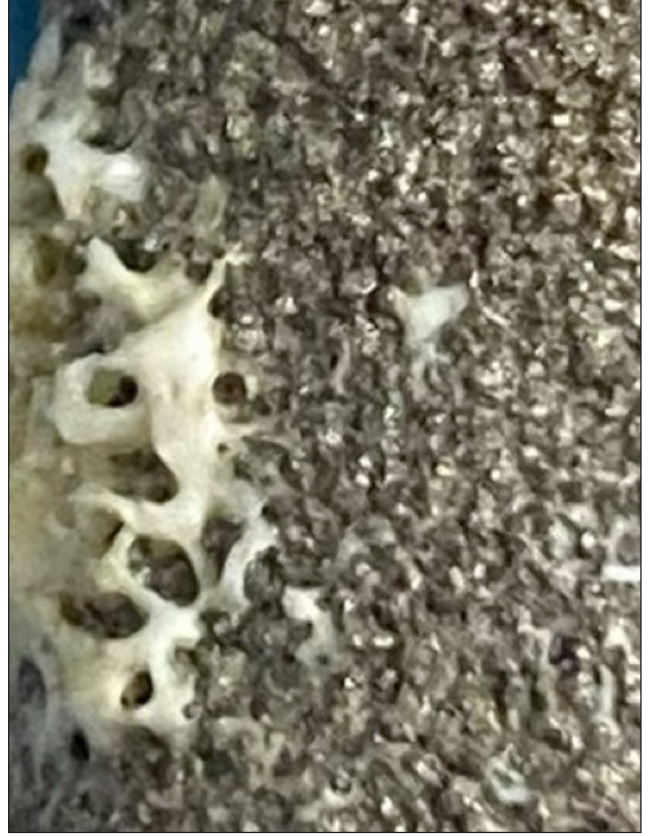
Şekil 1. Periprostetik kırık nedeniyle çıkarılan femoral stemin proksimal poröz metal yüzeyinde, implant porları içerisine doğru uzanan ve poröz yapıyı dolduran olgun kemik dokusu ile uyumlu makroskopik osseoentegrasyon görünümü. Poröz metal-kemik arayüzünde belirgin kemik tutunması ve biyolojik fiksasyon bulguları izlenmektedir.
