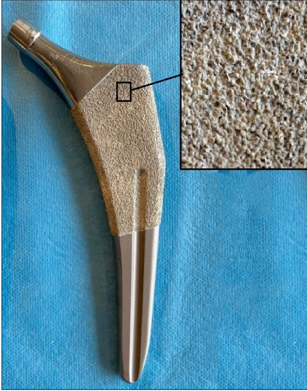
Şekil 5. Proksimal tutulumlu femoral stemin proksimalinde, titanyum plazma spray yöntemiyle oluşturulan poröz yüzey ve bunun üzerine uygulanan hidroksiapatit kaplama; sağ üst köşede yüzey mimarisinin büyütülmüş görünümü gösterilmektedir.
