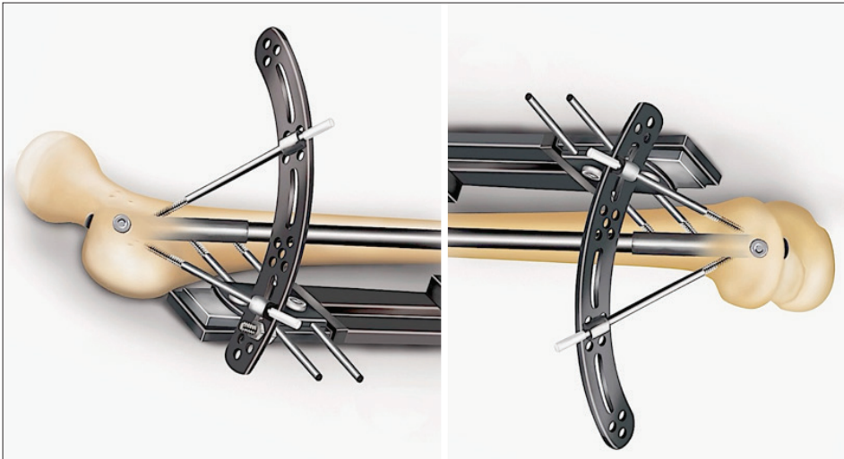
Şekil 8. Stabiliteyi artırmak amacıyla, farklı planlarda Schanz vidası yerleştirilmesine olanak tanıyan pelvik arkları, proksimal ve distal femoral kemik segmentlerde unilateral fiksatorler birlikte kullanıldığı hibrid eksternal fiksator sistemi.
