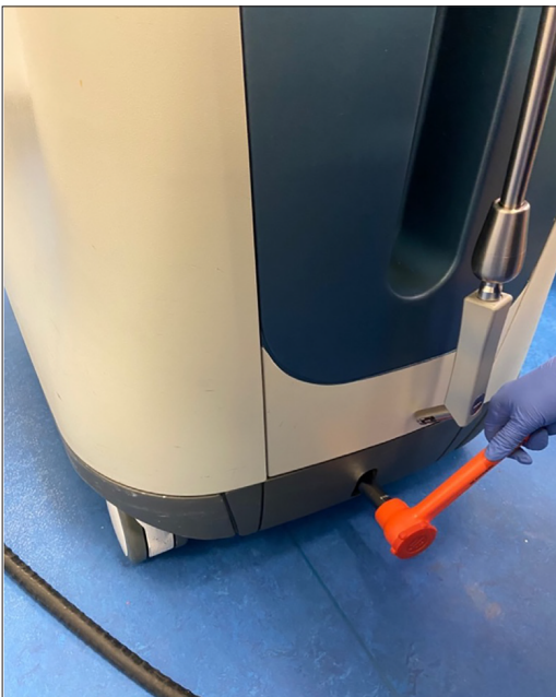
Şekil 3. Robotun ana gövdesini hareket ettiren sistem bozulduğunda manuel olarak hareket elde edilebilir.
